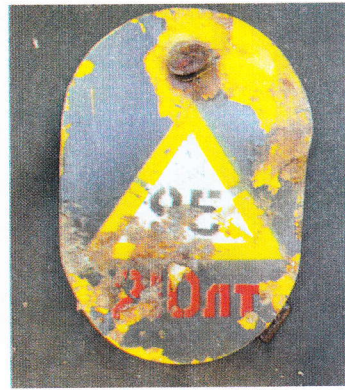
Лючок заливной горловины топлива: 210 литров, октановое число топлива 95
