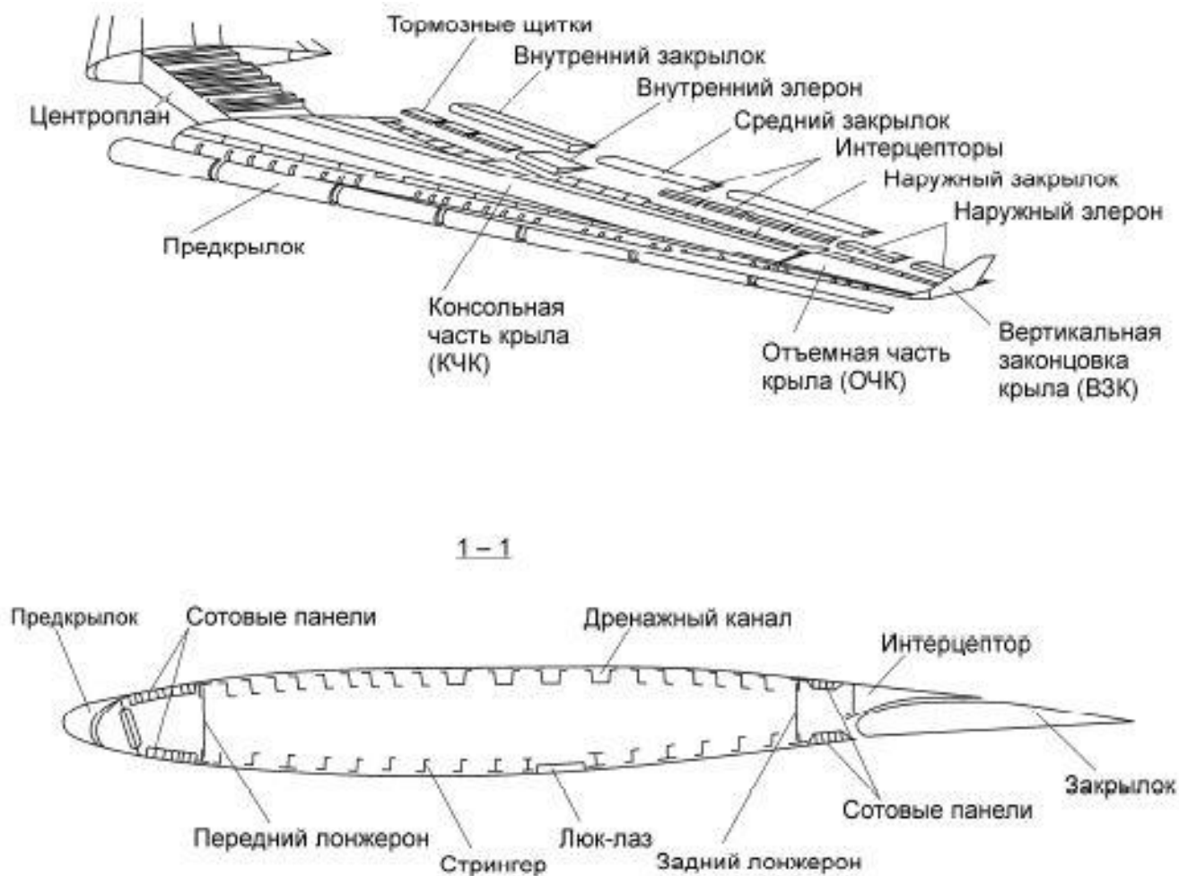
Рис. 8.2 Механизация крыла
