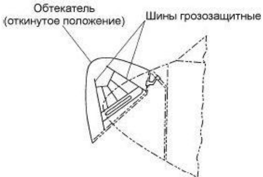
Рис. 31.5 Установка шин грозозащиты носового обтекателя
