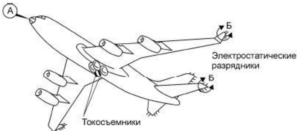
Рис. 31.1 Схема грозозащиты самолета
