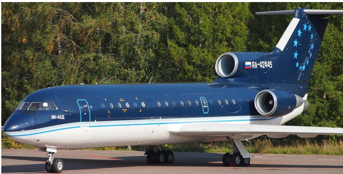
Наличие трех мощных двигателей и крыла оптимизированного для эксплуатации с коротких взлетно-посадочных полос вело к относительно высокому расходу топлива, а, следовательно, ограниченной дальности полета. (2000 км.).
