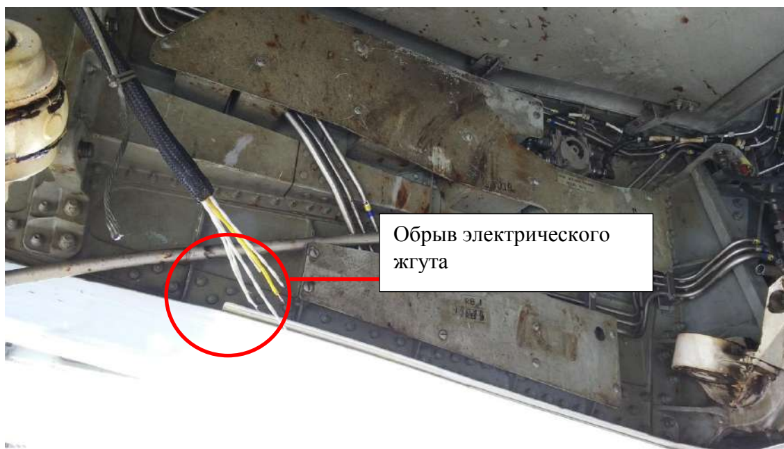
Рис. 61. Обрыв электрической проводки в нише левой ООШ
