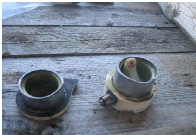
Рис. 14. Элементы слабых звеньев переднего подкоса левой ООШ
