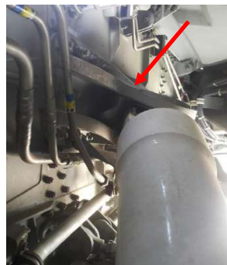
Рис. 19. Проушины кронштейна крепления гидроцилиндра уборки-выпуска правой ООШ
