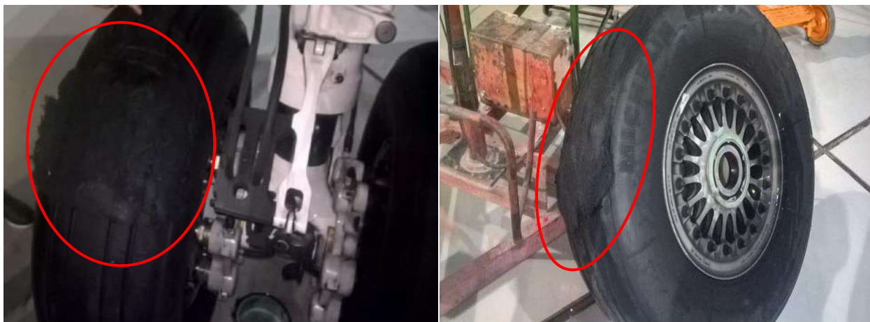
Рис. 39. Повышенный износ пневматиков ООШ RRJ-95LR-100 RA-89038
