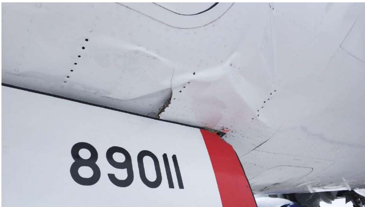
Рис. 4. Разрыв обшивки в районе передней опоры шасси
