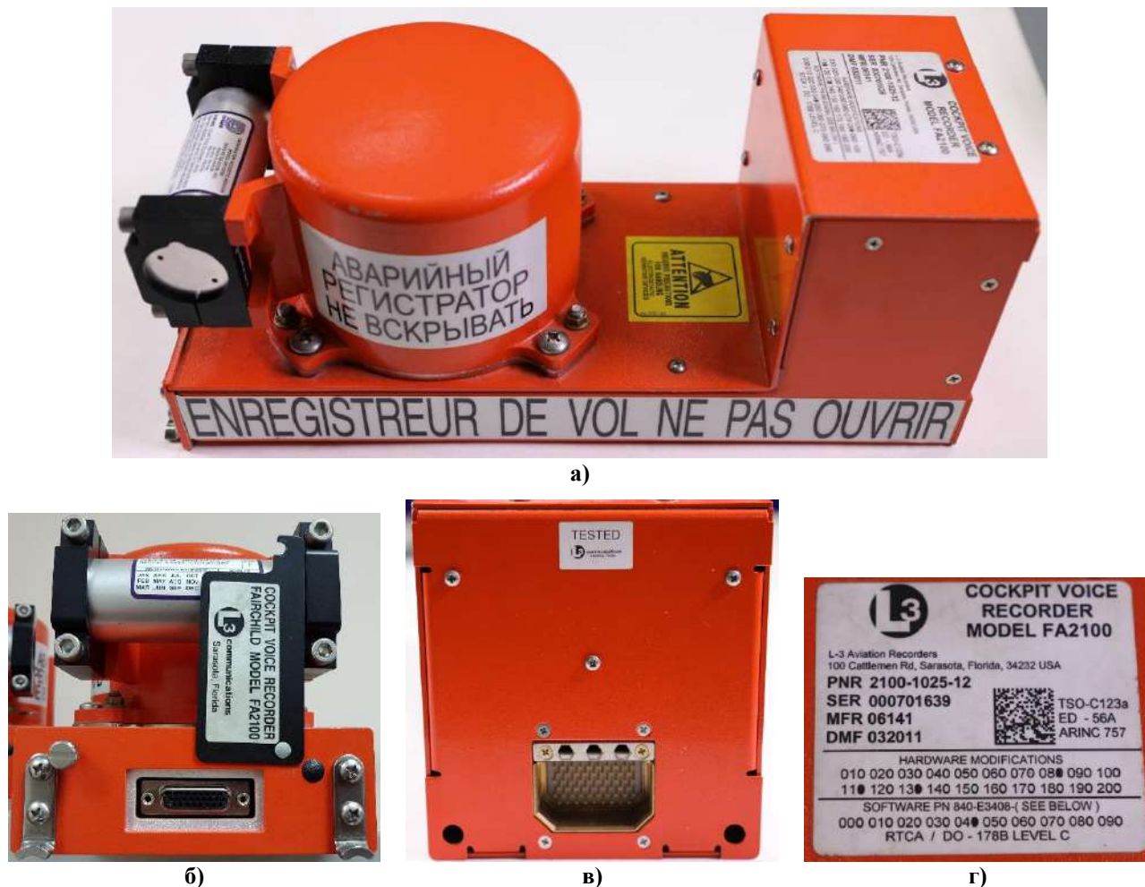
Рис. 32. Фотографии бортового речевого регистратора: а) общий вид; б) разъем на передней панели; в) разъем на задней панели; г) этикетка с маркировкой прибора
