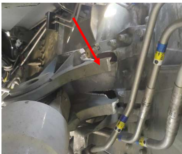
Рис. 18. Проушины кронштейна крепления гидроцилиндра уборки-выпуска левой ООШ
