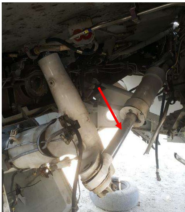
Рис. 16. Гидроцилиндр уборки-выпуска ООШ левой
