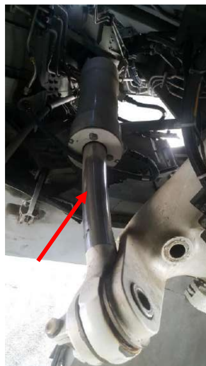
Рис. 17. Гидроцилиндр уборки-выпуска ООШ правой
