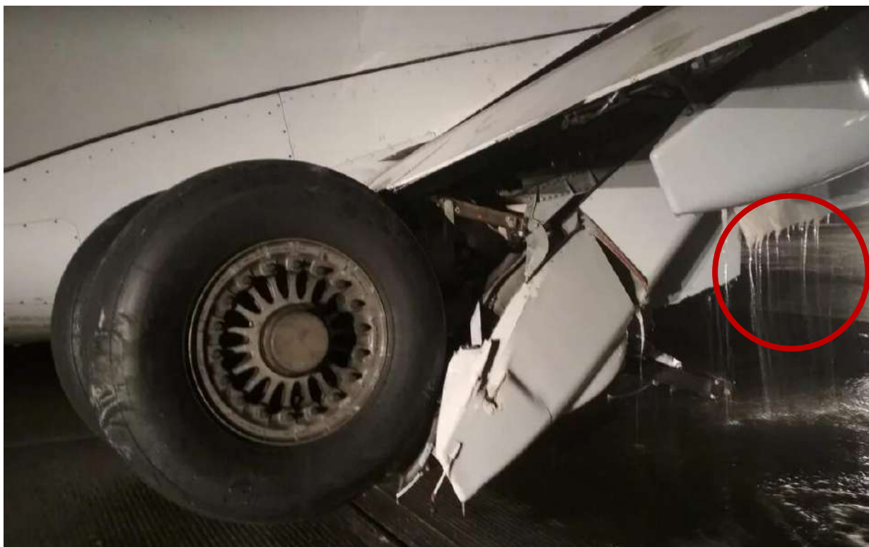
Рис. 24. Течь топлива из правого крыльевого бака, фото через 2 часа после АП
