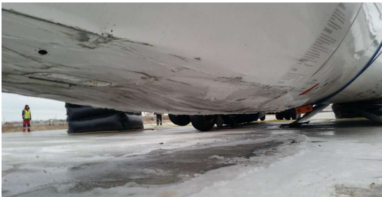
Рис. 3. Деформация обшивки, шпангоутов с 45 по 51 и многочисленные сквозные пробоины
