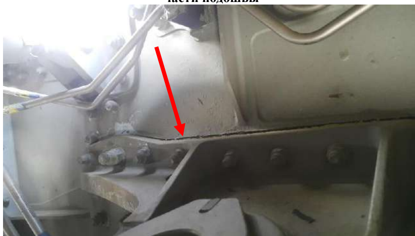
Рис. 21. Зона крепления кронштейна гидроцилиндра уборки-выпуска правой ООШ по верхней части подошвы
