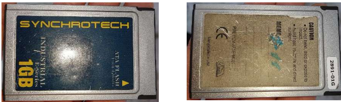
Рис. 33. Внешний вид эксплуатационного накопителя параметрической полетной информации
