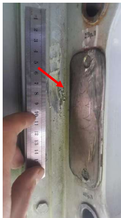
Рис. 12. Трещина в нижней части внешнего фитинга крепления узла «А» ООШ правой
